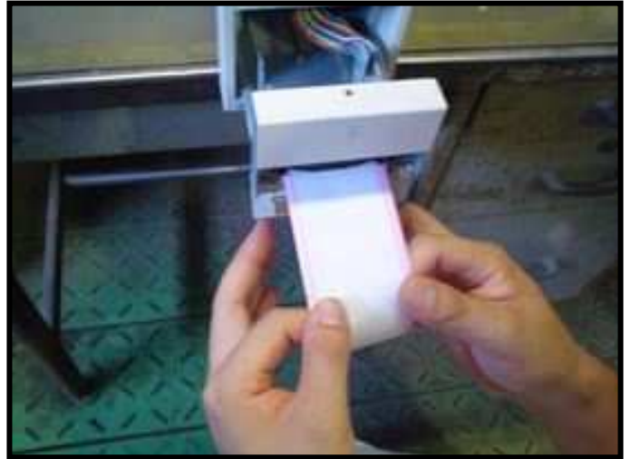
⑧残った紙を引き出します。(真っ直ぐ優しく引き出して下さい)
