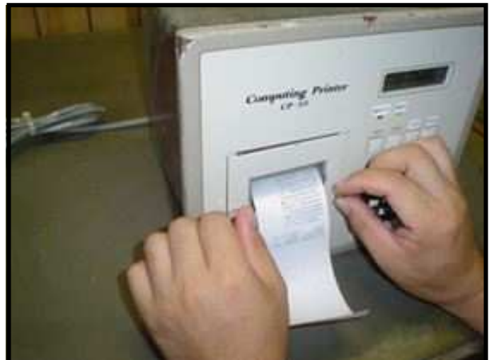
②フロントパネル脱着用の2本のネジを緩めます。
