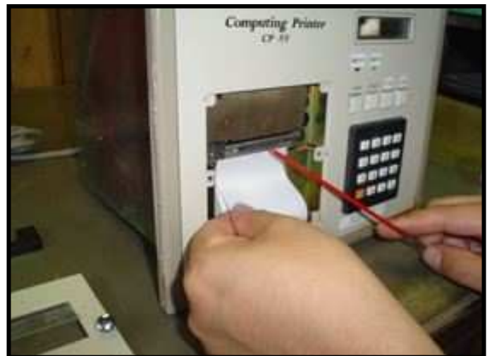
⑫棒先端が紙送りローラーです。紙を下から上に持ち上げつつローラーを指で下方方向に回してください。
