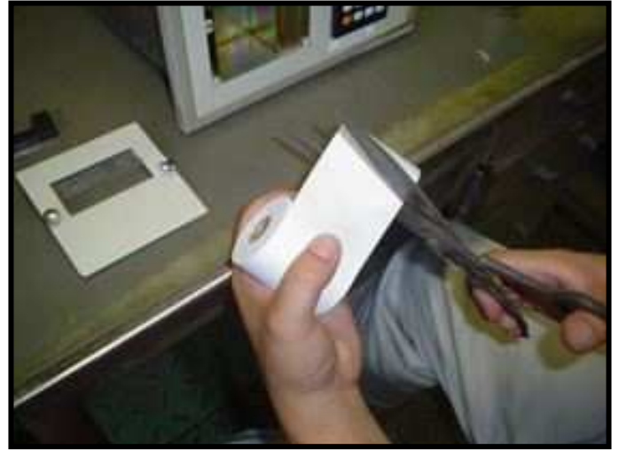
⑧交換用の紙の準備です。紙の先端を真っ直ぐにカットします。
