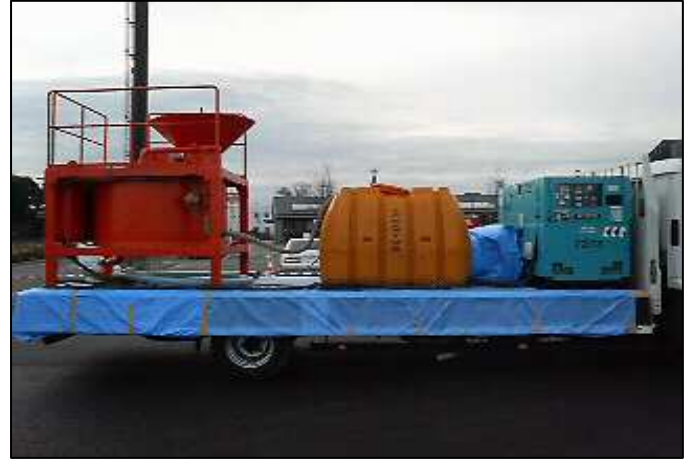
●4tトラックに写真のように前から①発電機②ローリータンク③プラントミキサーの順に積載します。
