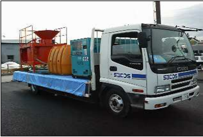
●4tトラックに写真のように前から①発電機②ローリータンク③プラントミキサーの順に積載します。
