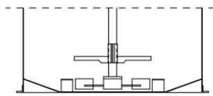
減速機 5.5KW 131R<sub>p</sub>M/min
