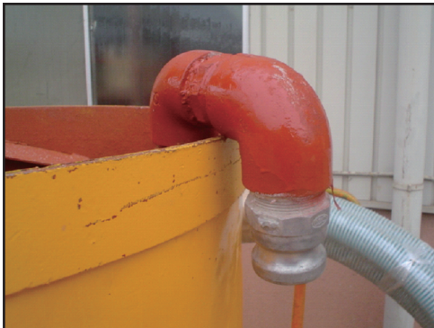
ミキサーにもホースをつなぐだけ
