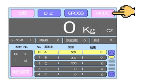
2) 原料毎設定を押します。(画面が原料毎設定に移行します。)
