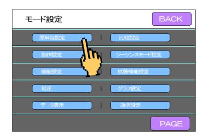
3) △と▽キーで変更したい原料を選びOKキーで確定させた後 落差キー を押します。画面がテンキーへ移行します。
